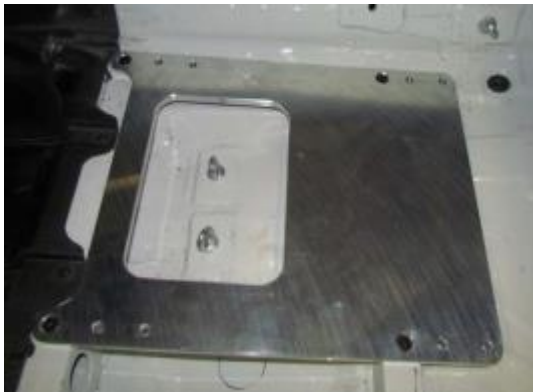
Bild 3.3.2: Grundplatte Sitzbefestigung montiert auf Traverse Sitzbefestigung
